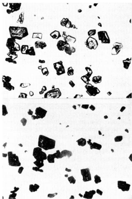
a Basisches Kupferchlorid I, \text{Cu}(\text{OH})\text{Cl} . b Basisches Kupferchlorid \text{II}\gamma ( \equiv Paratakamit) aus I und Wasser.
